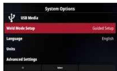
Seguendo le indicazioni sullo schermo, selezionando il tipo di materiale, spessore e il tipo di giunto imposterà tutti i parametri corretti per una saldatura facile e di qualità
