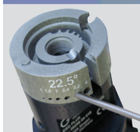
Affilatura: 4 angoli e 6 diametri diversi
