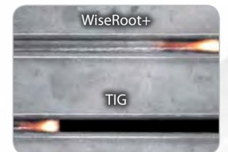
Con WiseRoot+, la saldatura di prima passata richiederà fino a un quinto del tempo della saldatura TIG.
